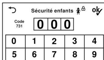
Après le déverrouillage, l'appareil peut être utilisé normalement. La sécurité enfants est activée automatiquement dès qu'un programme est démarré.
